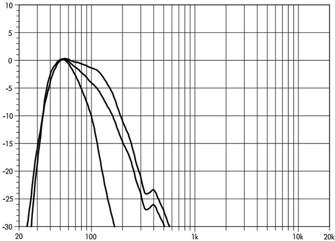
Réponse en fréquence du B6-SUB, mode standard, mode 100 Hz et mode INFRA
